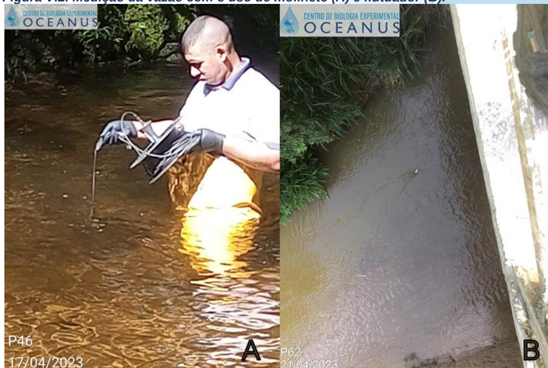
Figura V.2. Medição da vazão com o uso de molinete (A) e flutuador (B).
