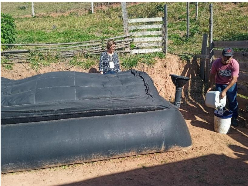
*Figura 118 - Biodigestor com sua parte superior com gás*
